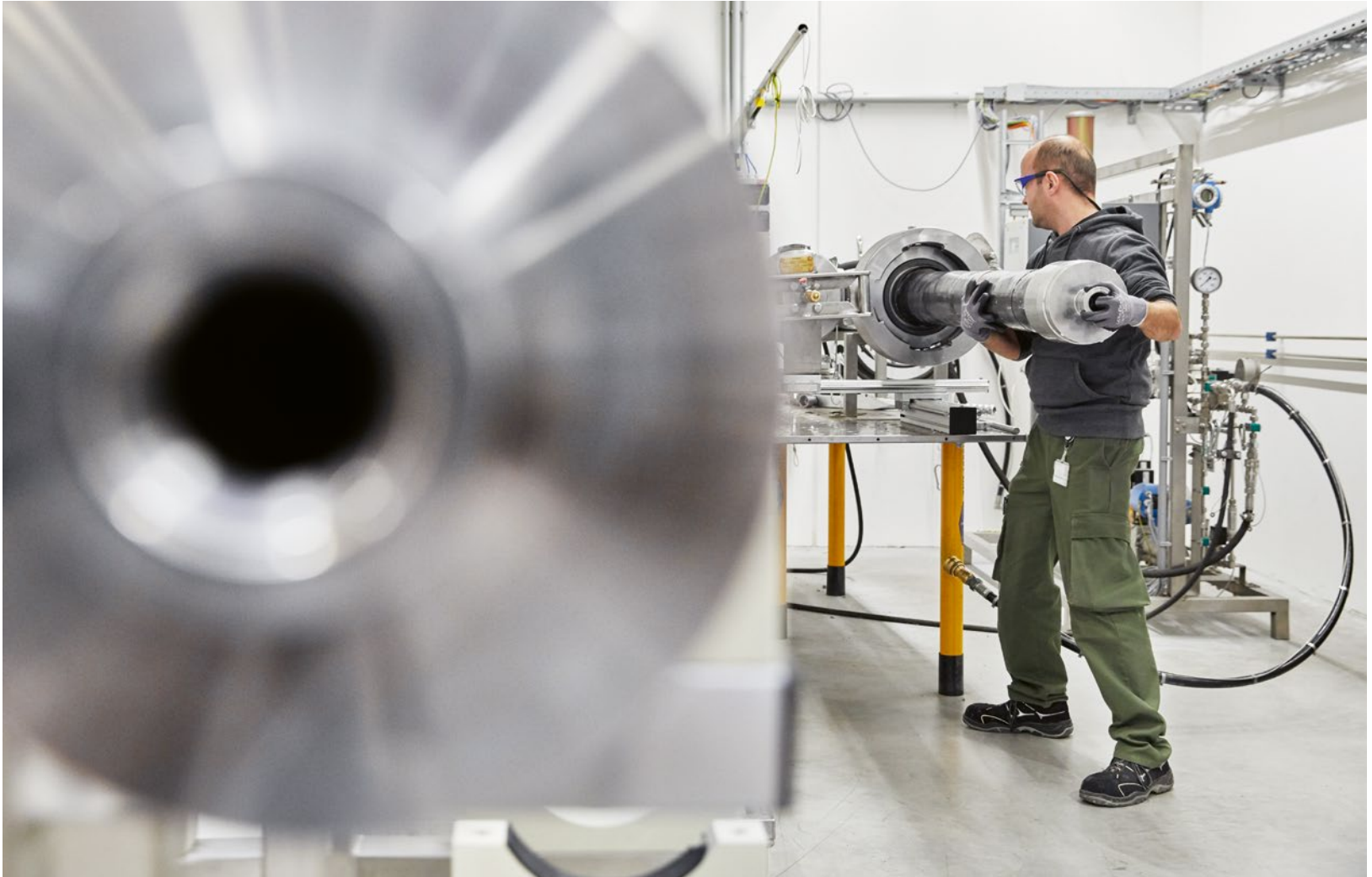
Kontrolle ist besser: Eine Membrankartusche wird in ein Druckrohr eingeführt und danach auf ihre Leistungsfähigkeit getestet.
