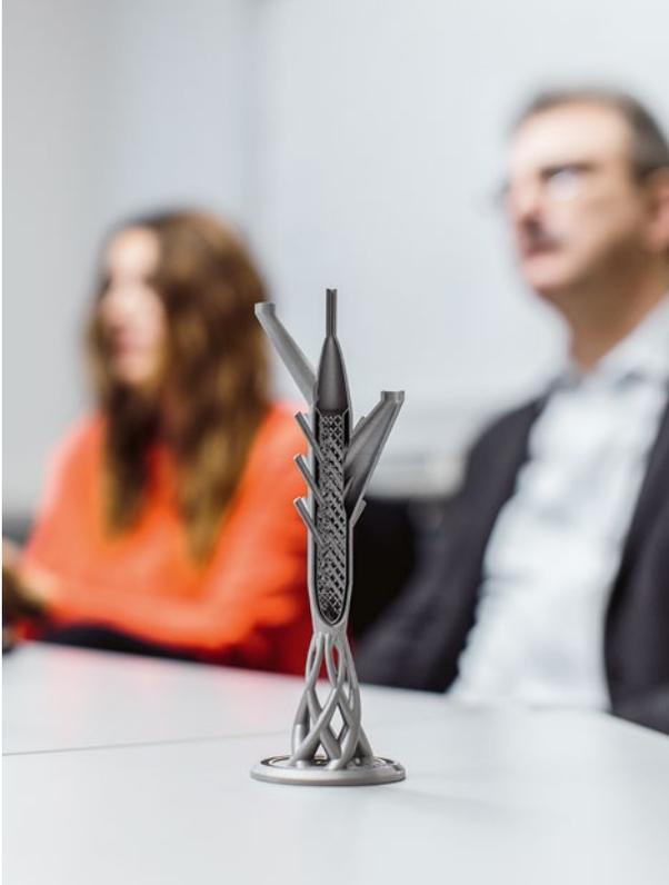
Das Innenleben eines aus Stahl gedruckten Demonstrationsobjekts
