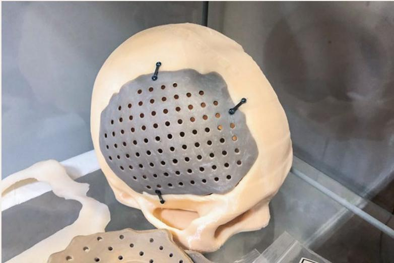
Reine Kopfsache: Vestakeep-Filamente werden heute bereits in Schädel-, Gesichts- und Kieferimplantaten verwendet.
