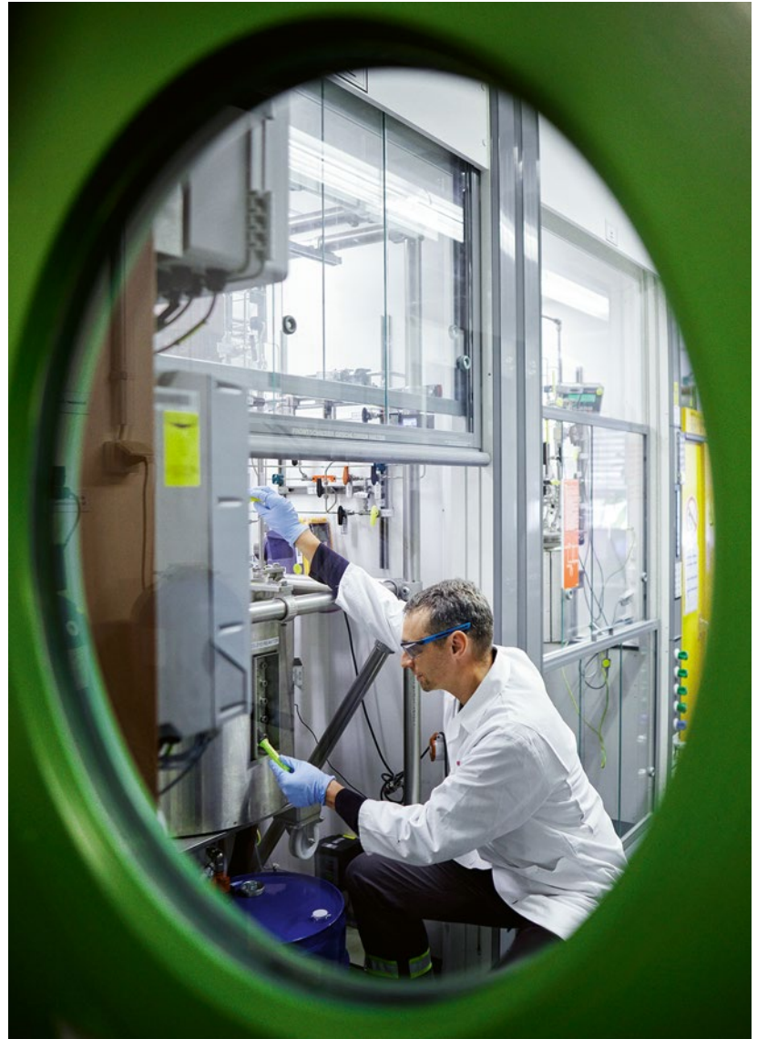
Der 50-Liter-Reaktor wird mit den Startmaterialien befüllt. Michael Reuter prüft den Inhalt.
