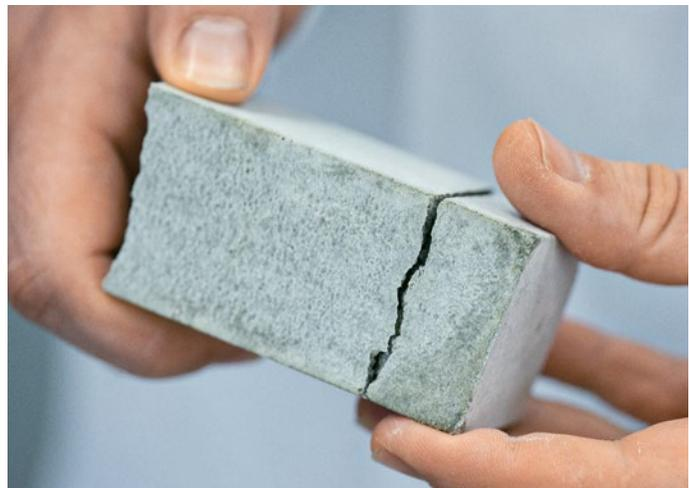
Im Labor werden Belastungsrisse provoziert, die sich dank WallCraft wieder von selbst verschließen.
