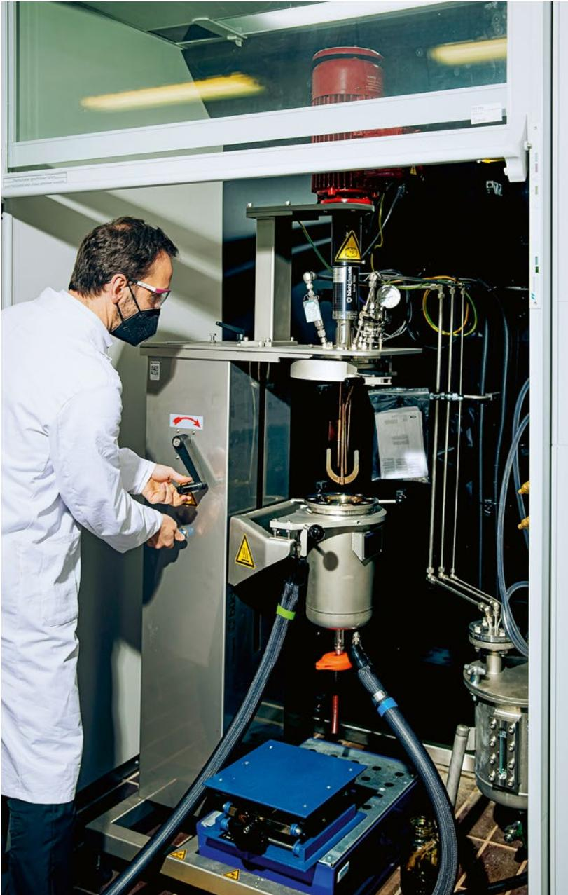
Um seinen Fünftliter-Hydrolysereaktor mit den Reaktanden zu befüllen, muss Michael Ferenz kräftig kurbeln.
