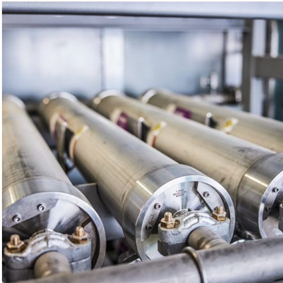
Module mit Evonik-Membranen trennen das vorgereinigte Biogas in Biomethan und Biokohlendioxid.
