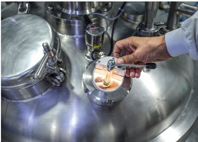
Im Mischreaktor werden aktive Wirkstoffe, das Trägersystem und weitere Inhaltsstoffe mit Glycerin und Wasser vermengt und über Stunden zu einer Lösung verrührt.
